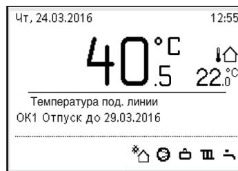
Если установлено 2 отопительных контура или более, перед прерыванием программы "Отпуск" нужно выбрать соответствующий отопительный контур в стандартной индикации.
